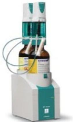
Автоматический волюмометрический титратор 901 Titrandо является самым современным и точным прибором в линейке КФ титраторов Metrohm. Помимо волюмометрического титрования прибор может решать много других задач и обладает рядом уникальных особенностей.
