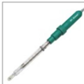
контроля позволяет не допустить использование электродов, чьи калибровочные данные лежат вне допустимых пределов, или чей период калибровки уже истек. Также электрод iTrode можно использовать с различными приборами без перекалибровки, благодаря сохраненным на чипе данным о калибровке.
